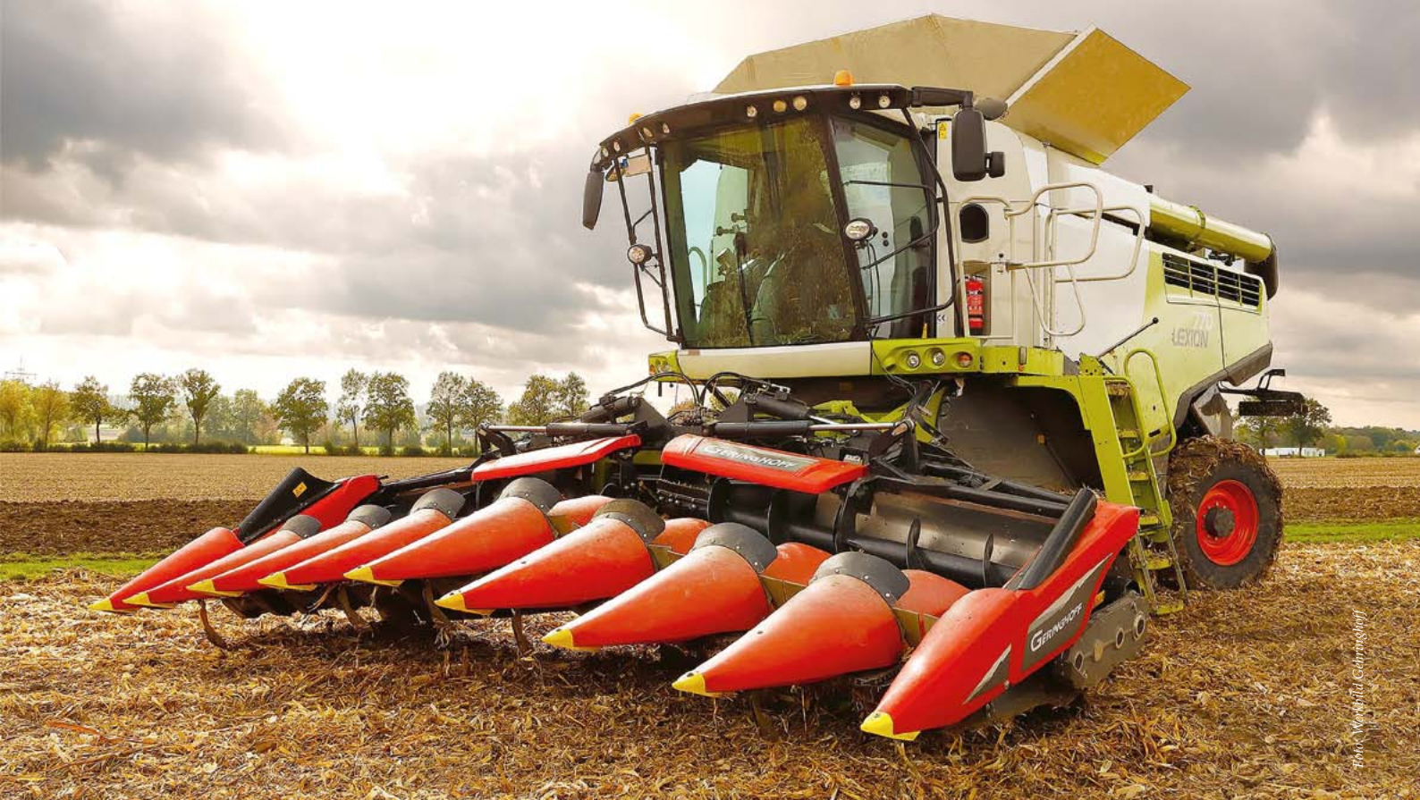
Der Maisvorsatz Horizon Star III Razor von Geringhoff mit integrierter Stoppelbearbeitung und flexiblem Rahmen.
